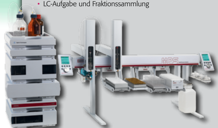
DualHead-MPS-LC für die automatisierte dispersive SPE (DPX) mit nachfolgender HPLC-Probenaufgabe
